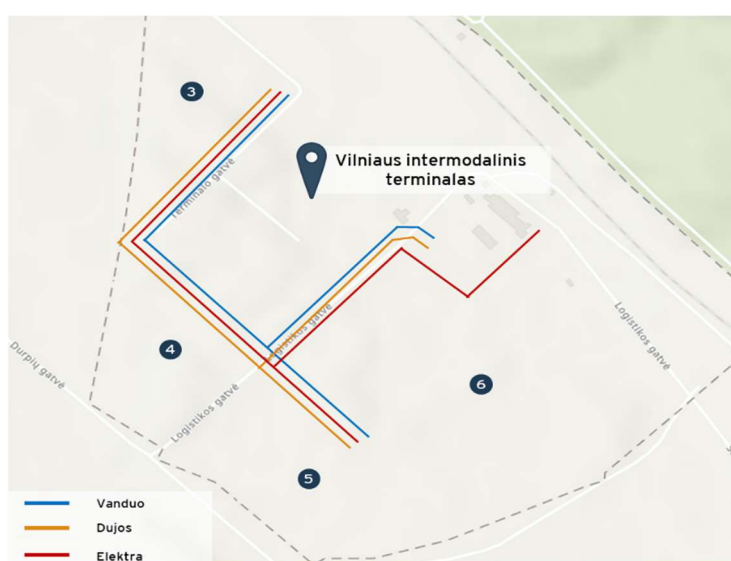
1 pav. Vilniaus viešojo logistikos centro inžinerinių tinklų schema
